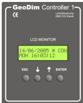
CoOntroller 1 - Programmierbare DMX512 Beleuchtungssteuerung für Außenbeleuchtung, Messestand, Fassadenbeleuchtung, Werbeanlage, Schaufenster, Kino, Schwimmbad oder Tierstall.
